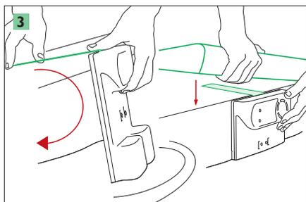
Sensor Espio™ doit parfaitement se plaquer sur la paroi. Au besoin ajustez le support de fixation.
