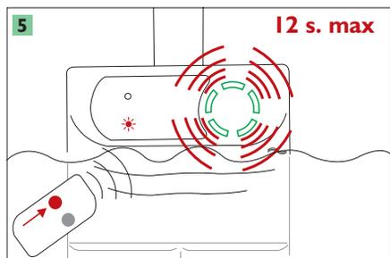
La sirène doit retentir 12 secondes maximum après la chute. Arrêtez la sirène avec le bouton rouge de la télécommande.
