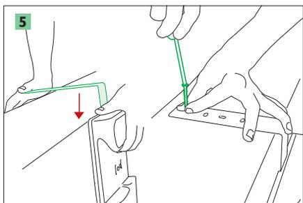
Serrez les 2 vis et remettez en place la margelle.
