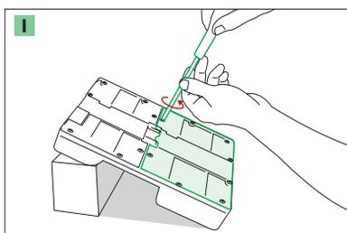
1 Placez Sensor Espio™ sur une cale comme indiqué. Dévissez les vis du compartiment de piles.
