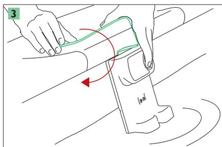
Sensor Espio™ doit parfaitement se plaquer sur la paroi. Au besoin ajuster le support de fixation. En cas d'espace entre le support de fixation et la margelle, placez-y la mousse de calage (si nécessaire découpez-la à l'aide d'un cutter pour l'adapter).
