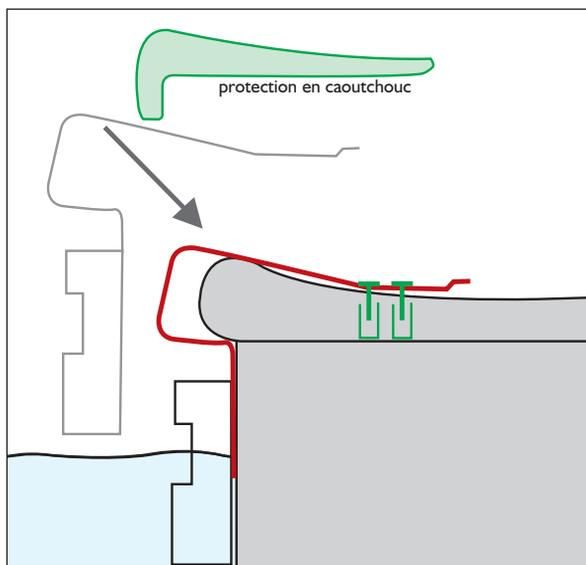
Sensor Espio™ doit impérativement être plaqué contre la paroi du bassin.
