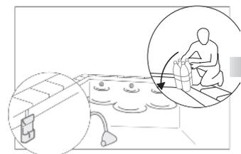
Filtration et robot en marche, du point le plus éloigné de Sensor Espio™, faites chuter du haut de la margelle le poids de 6 kg. La sirène doit retentir 12 secondes maximum après la chute.
