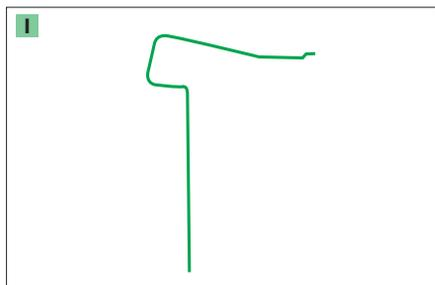
Support de fixation adapté à la pose sur margelle pour bassin existant.
