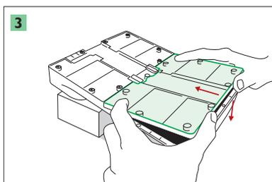
3 Vérifiez que le joint ne soit pas vrillé et soit suffisamment graissé avant de fermer le couvercle.
