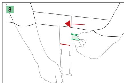
Insérez impérativement la cale fournie 5 cm au dessus du repère, entre la paroi du bassin et le support de fixation.
