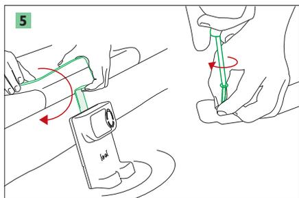
Clipsez à nouveau le support de fixation sur la margelle. En cas d'espace entre le support de fixation et la margelle, placez-y la mousse de calage (si nécessaire découpez-la à l'aide d'un cutter pour l'adapter). Serrez les 2 vis.
