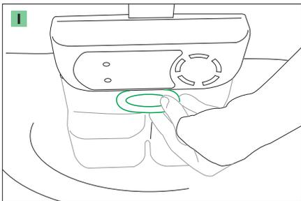
Déclipsez le cache vis éventuellement à l'aide d'un tournevis plat.
