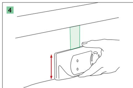
Faites coulisser Sensor Espio™ sur son support afin d'amener impérativement le niveau d'eau sur le repère de niveau.
