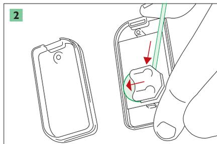
Sortez la pile usagée avec précaution à l'aide d'un tournevis.
