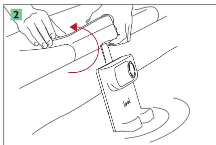
Manipulez impérativement Sensor Espio™ verticalement, compartiment de piles en bas.
